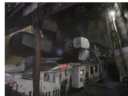
采煤机机载除尘器现场使用效果
