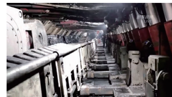
基于实时以太网的液压支架网络型控制系统 在阳煤新元煤矿成功应用
